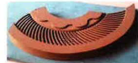
砂型3Dプリンター作製砂型
