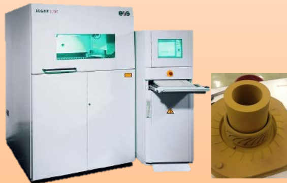
砂型3Dプリンター (レーザー焼結型積層造形装置)
