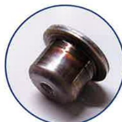
試作した燃焼圧センサ ダイヤフラム部
